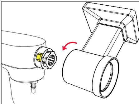
Positionner l'accessoire sur le connecteur et le faire tourner dans le sens contraire des aiguilles d'une montre, jusqu'à la butée (click).
