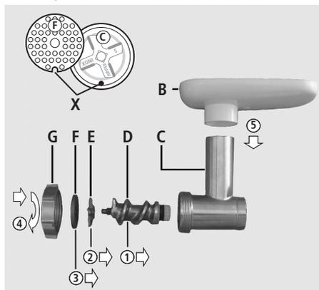
**1** Poussez jusqu'en butée la vis sans fin **D** – en plaçant le couplage en plastique en premier – dans le boîtier **C**.
