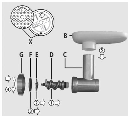
**1** Schieben Sie die Schnecke **D**, mit der Kunststoffkupplung voran, bis zum Anschlag in das Gehäuse **C**.
