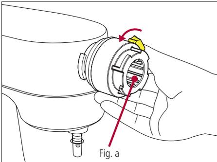
Kupplung auf dem Zubehöranschluss der Küchenmaschine anbringen und im Gegenuhrzeigersinn bis zum Anschlag drehen, allenfalls kann auch eine leichte Drehung des Führungsrades helfen (Fig. a).
