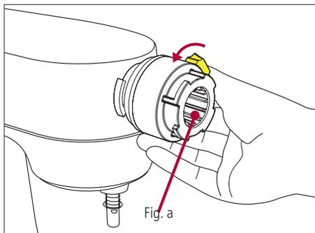
Positionner le connecteur sur le dispositif pour accessoires de la machine de cuisine et le faire tourner dans le sens contraire des aiguilles d'une montre, jusqu'à la butée. Si nécessaire, effectuer quelques rotations de l'engrenage (fig. a) pour l'insérer.
